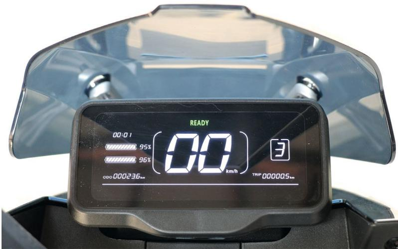
Zentral hinter der kleinen Windschutzscheibe angebracht ist das LC-Display, das auch bei Sonneneinstrahlung noch gut ablesbar ist. Statt eines Zündschlüssels wie beim SK1 besitzt der SK3 ein einfach zu bedienendes Keyless-System. Der LED-Scheinwerfer mit Positionslichtstreifen sorgt für eine ordentliche Ausleuchtung der Straße bei Nacht (unten). Serienmäßig ist der SK3 nur mit einem Akku ausgestattet, dann bleibt auch noch Stauraum für einen Jethelm.
